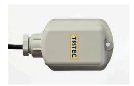
Il sensore di temperatura esterna Pt1000 rileva le temperature nell'ambito da – 20 fino a + 150°C. La struttura macrolonge resistente alle intemperie, ai raggi UV e agli spruzzi d'acqua lo protegge dagli influssi esterni. Attraverso la sua costruzione compatta, esso è utilizzabile in modo flessibile e può essere montato in quasi tutti i luoghi. La struttura in plastica è dotata di una cavo di collegamento a doppia anima.
