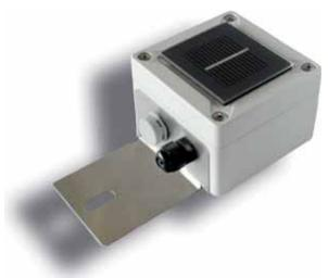
Lo Spektron 320 può emettere quattro diversi segnali di uscita, poichè è dotato di un circuito integrato di amplificazione. Questo circuito deve essere alimentato da 5 a 30 V DC o da 12 a 30 V DC.
